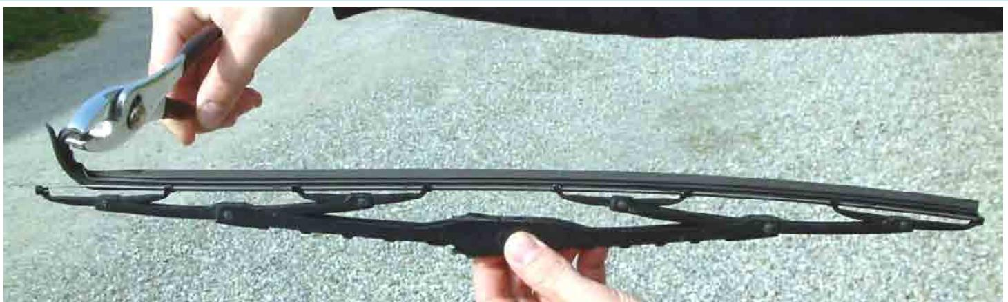
2. Den Keil durch die Metallhalterung durchziehen, damit die Öffnung für den Scheibenwischer-Ersatzgummi stimmt.
