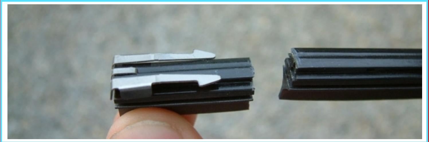
3. Das Scheibenwischer-Ersatzgummi mit der Seite einfahren, wo die Metallklammer abgeschnitten wurde. Jetzt den Scheibenwischer-Ersatzgummi durch die Plastikhalterklammer durchziehen bis es auf der anderen Seite an der geschossenen Halterung ansteht.
