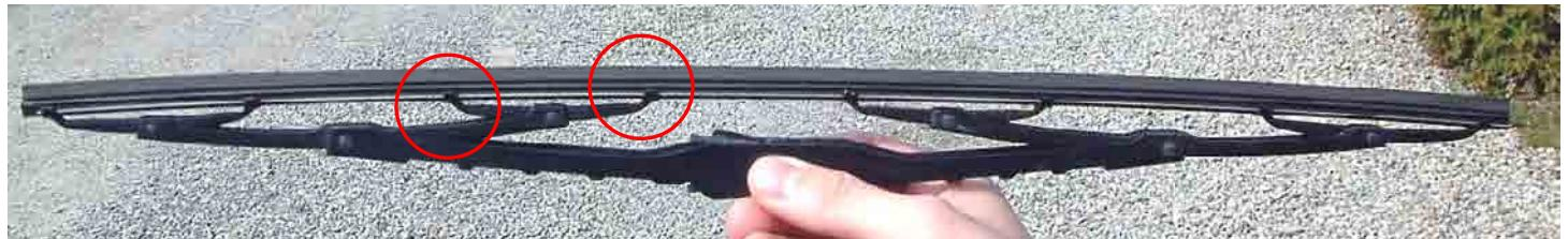
1. Bestehender, alter Scheibenwischer-Gummi mit dem Metallstäbchen aus dem Scheibenwischergestell herausziehen.
