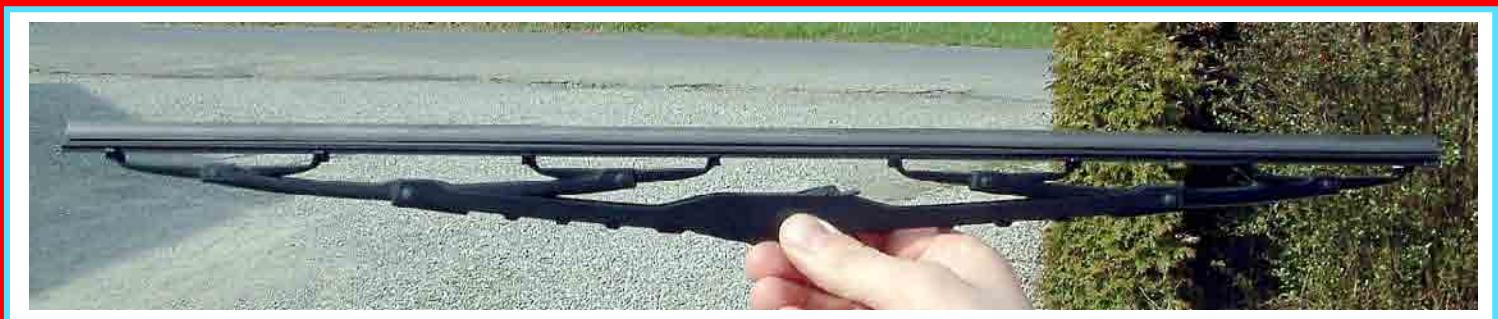
Das Scheibenwischerblatt wird nicht demontiert, es wird direkt auf dem Fahrzeug gewechselt.
