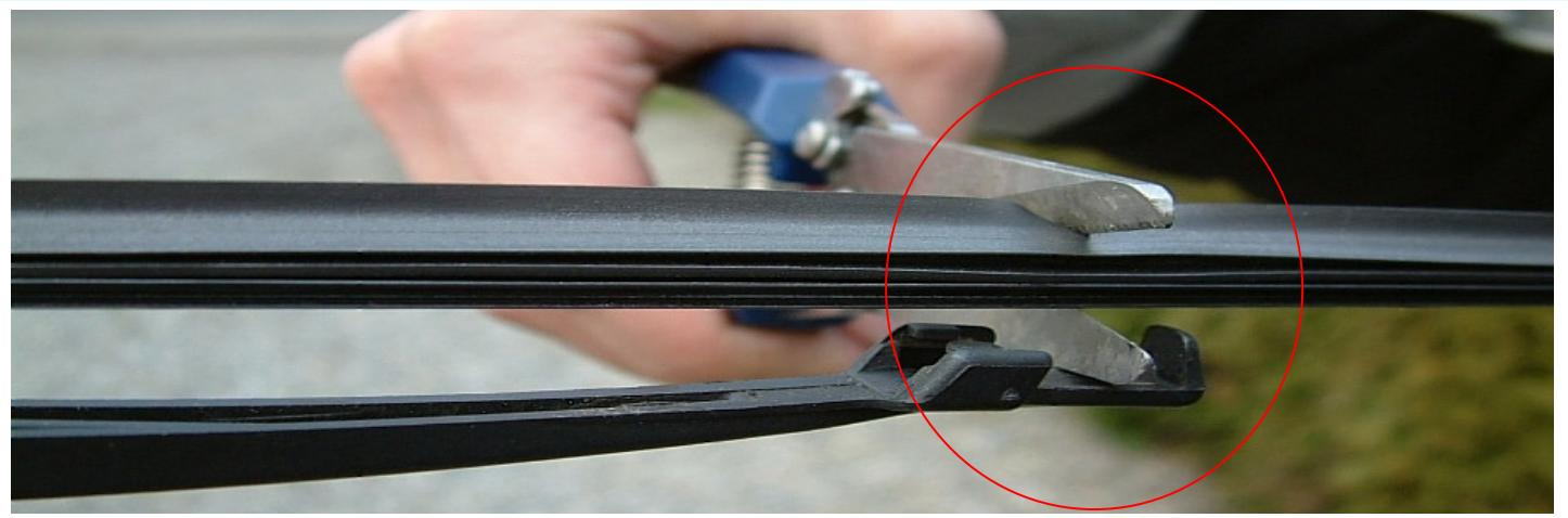
5. Das Scheibenwischer-Ersatzgummi biegen und in die letzte Plastikhälteklemme einfahren.
